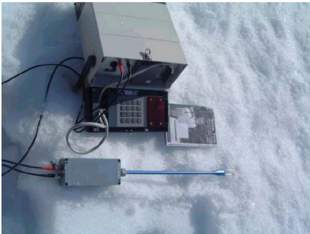
**Figura 6.2.2.2 ?** Rilievi con Snow Fork (Foto: cortesia del Centro Valanghe di Arabba)
